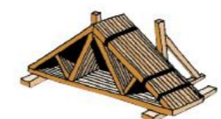
Il faut éviter que les fermes restent trop longtemps exposées aux intempéries. Dans le cas d'un stockage d'une durée supérieure à 15 jours, les fermes doivent être protégées par une bâche ou un plastique, tout en assurant une bonne ventilation. Cette protection n'est pas à la charge de CHAUSSON MATERIAUX.
