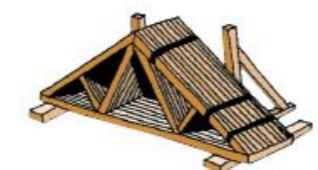
Il faut éviter que les fermes restent trop longtemps exposées aux intempéries. Dans le cas d'un stockage d'une durée supérieure à 15 jours, les fermes doivent être protégées par une bâche ou un plastique, tout en assurant une bonne ventilation.
