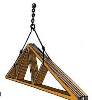
Les fermes industrielles sont conçues pour travailler dans le plan vertical. Les manutentions et le transport doivent s'effectuer verticalement et non à plat.
